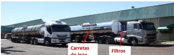
Filtrar em transporte, em veículos adequados. Carretas tanque de aço inox com sistema de filtração que permita a filtragem em movimento, assim o óleo estará homogêneo e os efeitos da filtragem serão melhores.
